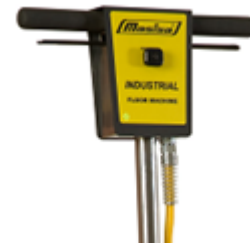
Caja – Switch con dispositivo de seguridad
